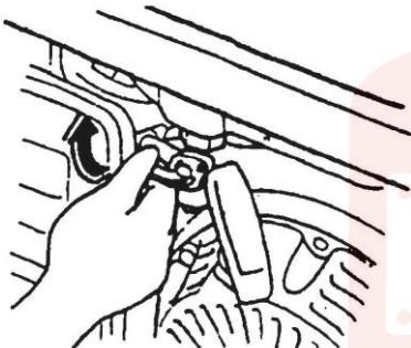
Важно! При необходимости срочной остановки двигателя переведите выключатель в положение "OFF".
