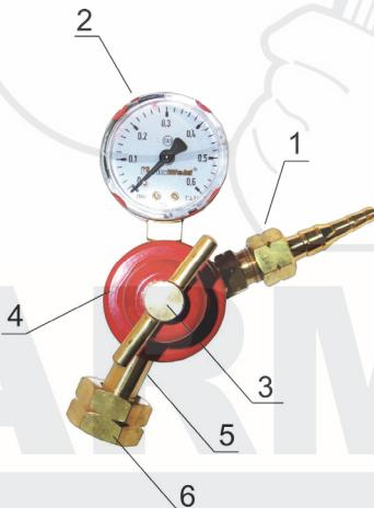
1. – штуцер выходной; 2. – манометр рабочего давления; 3. – регулирующий винт или маховик; 4. – корпус регулятора; 5. – штуцер входной; 6. – гайка накидная.
