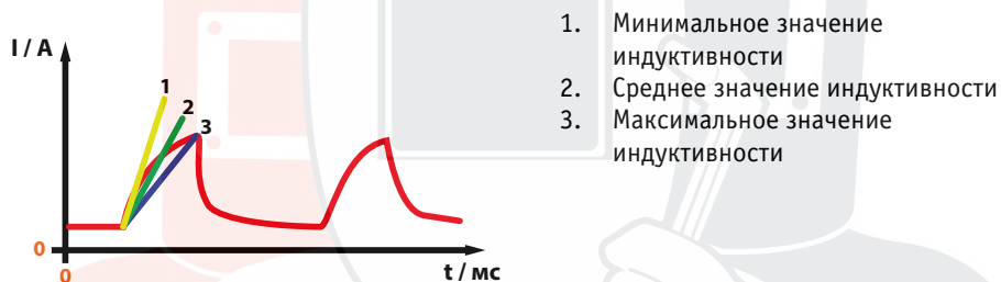
Рис. 8. График зависимости сварочного тока от индуктивности.
