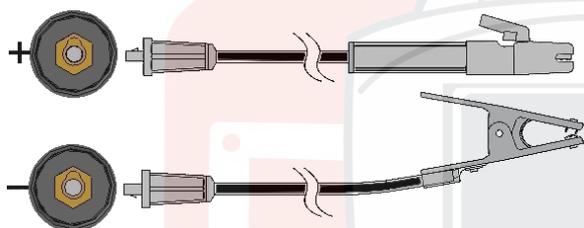
Подключите электродный кабель к терминалу обозначенному как (+), а кабель на деталь к терминалу (-). Вставьте сварочный разъем, выровняв его так чтобы выступ ключа входил в ответный паз и поверните его на ¼ оборота по часовой стрелке.
