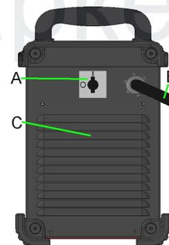
энергопотребление и количество пыли, попадаемое внутрь аппарата. В режиме сварки вентилятор работает, в режиме простоя, если нет сварки 5 минут, вентилятор выключается.
