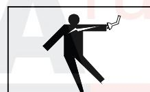
Категорически не допускается производить работы при поврежденной изоляции кабеля, горелки, сетевого шнура и вилки. Не касайтесь неизолированных деталей голыми руками. Сварщик должен осуществлять сварку в сухих сварочных перчатках, предназначенных для сварки.
