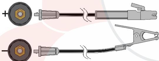
Подключите электродный кабель к терминалу (+), а зажим заготовки - к терминалу (-). Вставьте соединитель, выровняв его так, чтобы выступ ключа входил в ответный паз, и поверните его приблизительно на  $\frac{1}{4}$  оборота по часовой стрелке. Не затягивайте слишком сильно.
