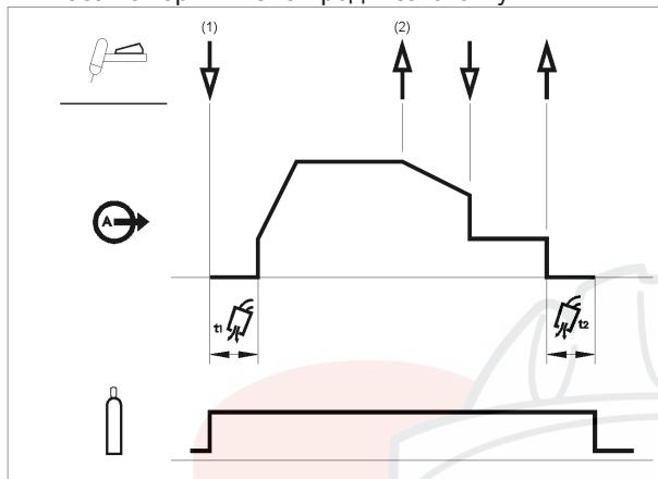
Как показано выше, можно нажать и удерживать курок ТИГ-горелки второй раз во время понижения тока, чтобы завершить функцию понижения и поддерживать ток сварки при токе кратера. При отпускании курка ТИГ-горелки происходит прекращение подачи сварочного тока и начинается заключительная подача защитного газа. Данная рабочая последовательность (2-шаговая без возможности повторного включения) является заводской установкой.
