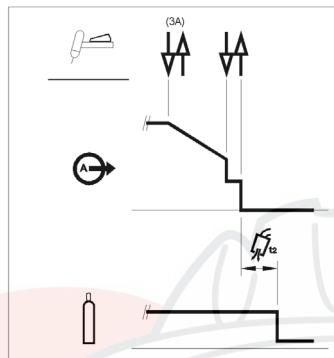
Данная рабочая последовательность (4-шаговая без функции повторного включения) является заводской установкой.
