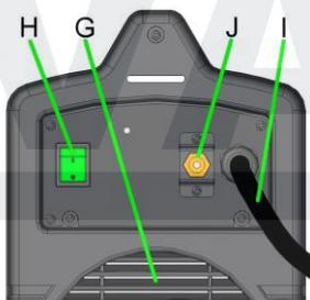
**Г. Вентилятор:** Обеспечивает охлаждение аппарата. При включении аппарата в сеть (ON) вентилятор продолжает работать до выключения аппаратов OFF.
