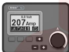
С ручкой для регулировки тока. Другие параметры регулируются с помощью кнопок с символами на панели дисплея.
