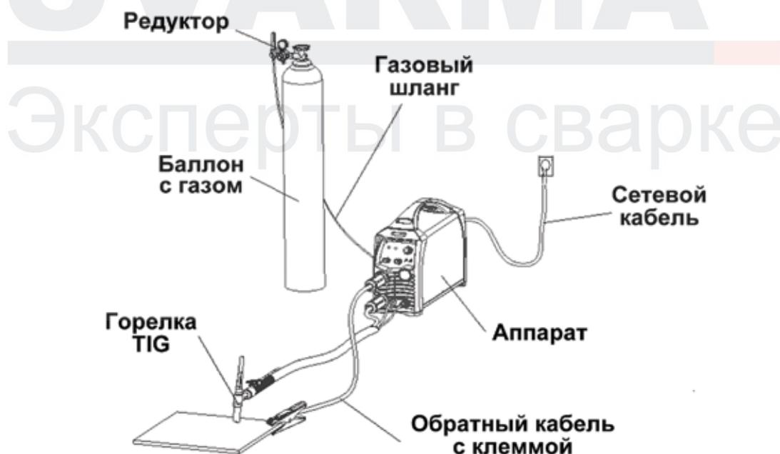
Рис. 6.2 Схема подключения оборудования для TIG сварки
