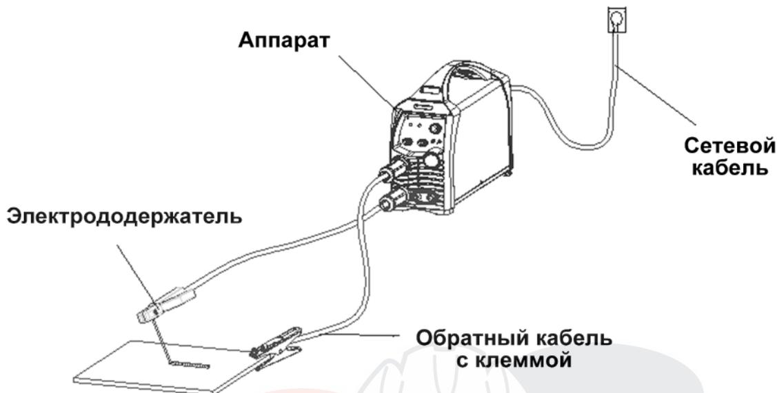
**Рис. 6.3** Схема подключения оборудования для ММА сварки
