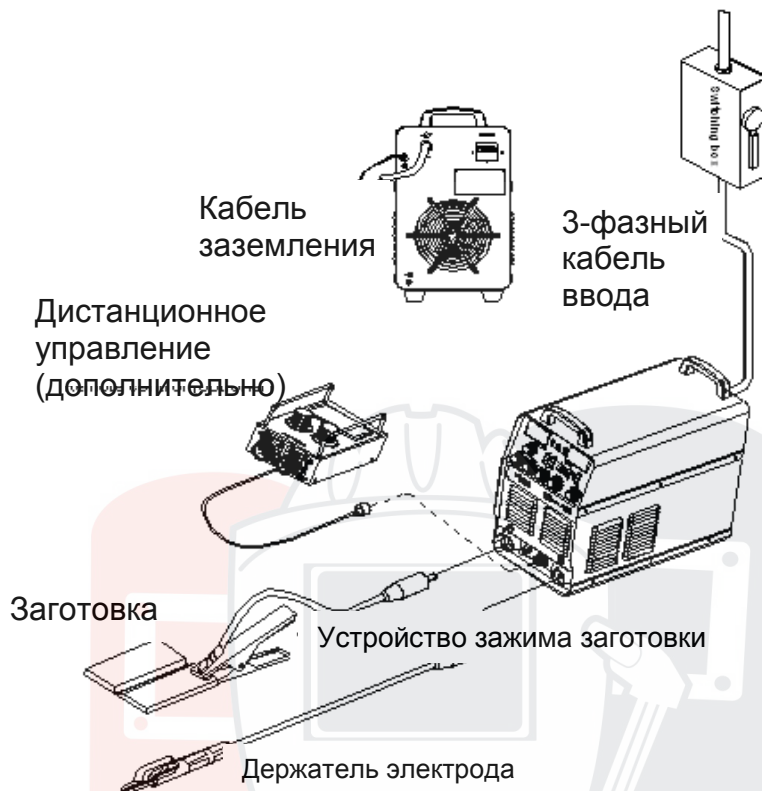
Рисунок 8.2.: Карта-схема установки при сварке ММА покрытым электродом
