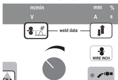
Дисплей сварочного тока и толщины свариваемого материала. Для переключения нажимайте кнопку под дисплеем. В процентах показывается напр. состав газа, и в секундах напр. время
