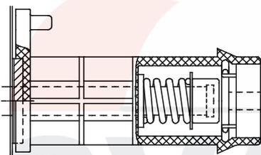
Регулируйте усилие тормоза кассеты с помощью отвертки через отверстие в ступице кассеты. Регулировочным винтом установите усилие таким, чтобы проволока не размоталась с кассеты при остановке подающих роликов. При применении высоких скоростей подачи, также усилие тормоза должно быть больше. Но, поскольку тормоз нагружает подающий двигатель, он не должен быть перетянут.
