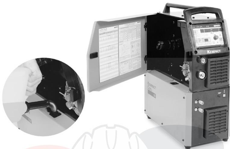
Заполните бак 20 – 40% смесью гликоля и воды или другим подходящим антифризом. Емкость бака составляет 3 л.
