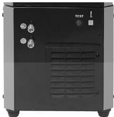
Работа блока охлаждения контролируется источником питания. Насос блока охлаждения включается автоматически когда начинается сварка. Происходит следующее:
