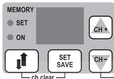
Импульсная панель включает в себя 100 каналов для записи сварочных параметров потребителя. В нижней части панели управления имеется сектор MEMORY для этих функций. Помимо сварочных параметров, также выбранные функции записываются в память.
