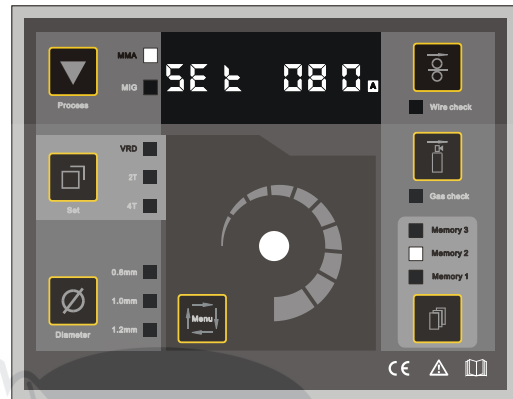
Рисунок 2: Режим MMA , установленный ток Рисунок 3: Режим MMA, установленный ток Функция VRD активна Функция VRD неактивна
