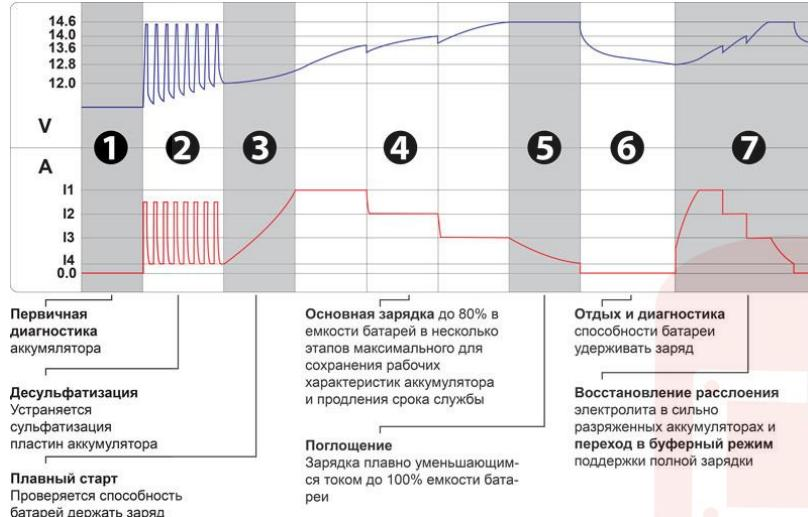
Система ступенчатой зарядки со встроенным микропроцессором :
