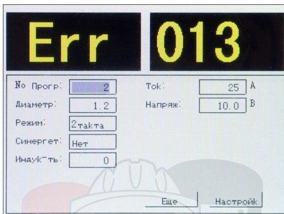
Рис. 6.3 Аварийное сообщение интерфейса в процессе работы
