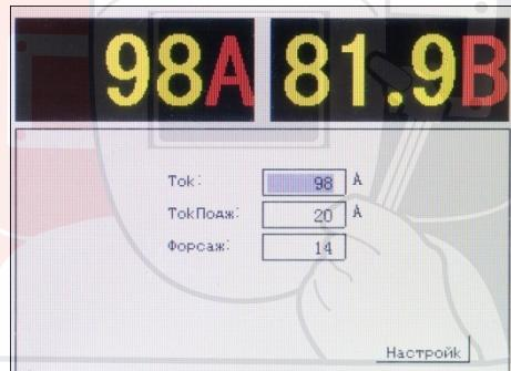
Рис. 6.5 Вид интерфейса в режиме ручной дуговой сварки
