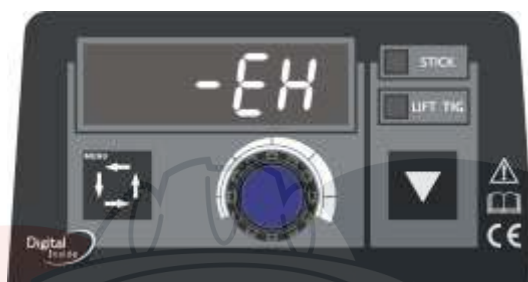
Рис 11 Дисплей при перегреве
