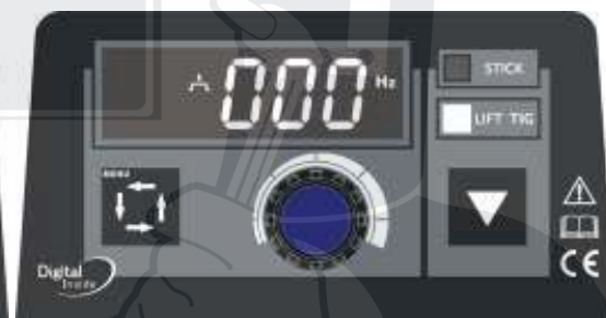
Рис 8 Регулировка базового тока в режиме пульс
