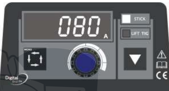
Рис 2 Индикация в режиме MMA
