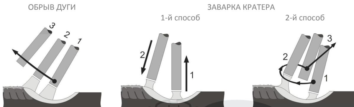
В конце шва нельзя обрывать дугу сразу. Электрод перемещают на край сварочной ванны (1,2) и затем быстро отводят (3) от кратера.
