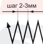
Прямые зигзагообразные движения применяют для получения наплавленных валиков при сварке встык без скоса кромок в нижнем положении и если нет вероятности прожечь деталь.
