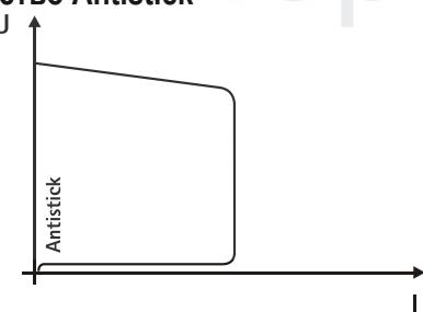
Устройство Antistick предотвращает прокаливание электрода.
