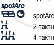
spotArc (диапазон времени сварки точки 0,01 - 20,0 с)<br><b>2-тактный</b><br><b>4-тактный</b>                                                               |
