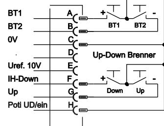
Горелка с функцией Up/Down или потенциометром для сварки TIG
