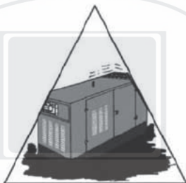
Неровное или недостаточно жесткое основание. Генератор установлен неправильно.
