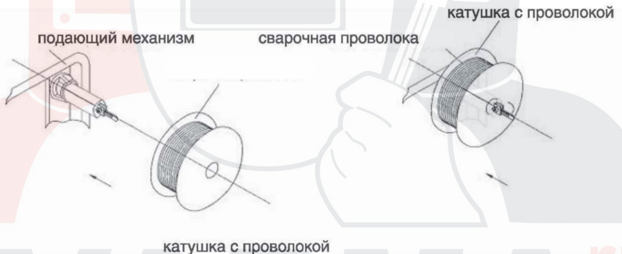
Рис. 5.3. Установка кассеты со сварочной проволокой
