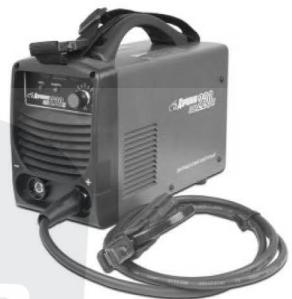
Управляющая электроника аппарата имеет встроенные функции стабилизации сварочного процесса - облегчения поджига дуги (Hot-start), функцию стабилизации и препятствию залипанию в процессе сварки (Arc-Force) и функцию снижения сварочного тока в случае замыкания электрода или электрододержателя (Anti-Sticking)
