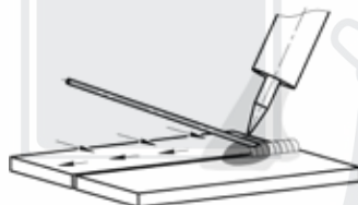
Рис. 8.6. Пример манипуляции присадочной проволокой при TIG сварке.
