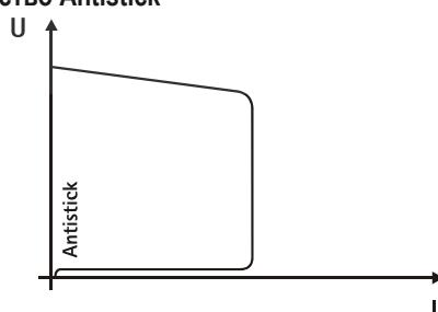
Устройство Antistick предотвращает прокаливание электрода.
