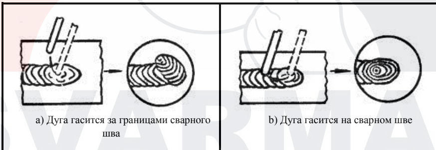
Рисунок 13.6 Способы гашения дуги
