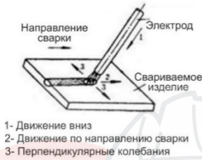
Рисунок 13.4 Три основных направления движения электрода
