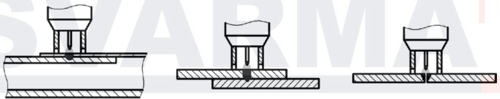
Рис. 9.24. Основные виды соединений при Spot сварке.
