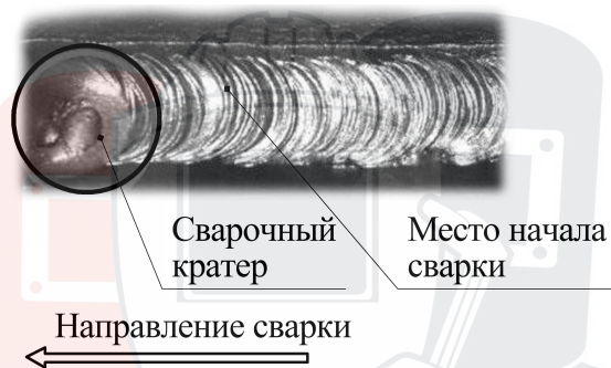
Рис. 7.5. Начало сварки при смене электрода.
