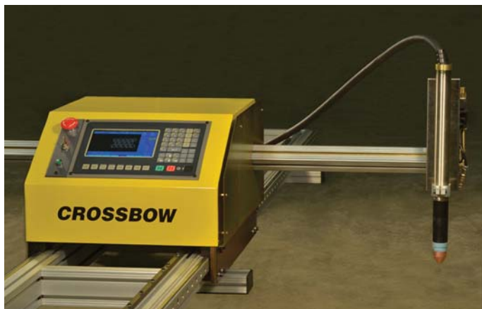
Максимальная толщина при плазменной резке: 20 мм
