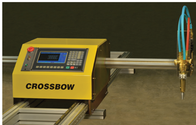
Максимальная толщина при кислородно-топливной резке: 100 мм
