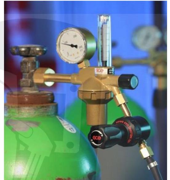
Нерегулируемая версия **GS40F** устанавливается на редуктор с расходомером в виде манометра и не требует изменений в работе; расход настраивается также вращением вентиля на редукторе.
