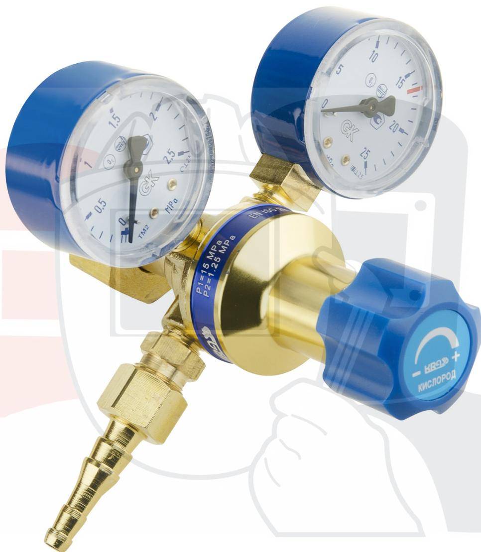
Малогабаритные редукторы - компромисс между функциональностью и доступностью. БКО-50-12,5 означает расход до 50 кубометров в час и рабочее давление до 12,5 атмосфер.
