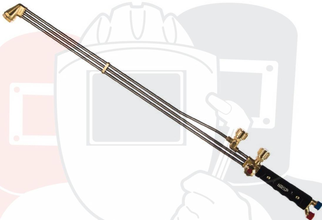
Новое поколение трехтрубных резаков с внутрисопловым смешением газов. Резаки предназначены для ручной газокислородной резки (раскроя) листового и сортового металла из низкоуглеродистых сталей толщиной до 300 мм.
