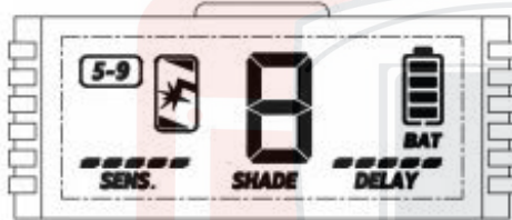
Рис. 7.2.1. Диапазон затемнения светофильтра 5-9 DIN.
