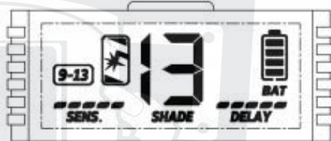
Рис. 7.2.2. Диапазон затемнения светофильтра 9-13 DIN.
