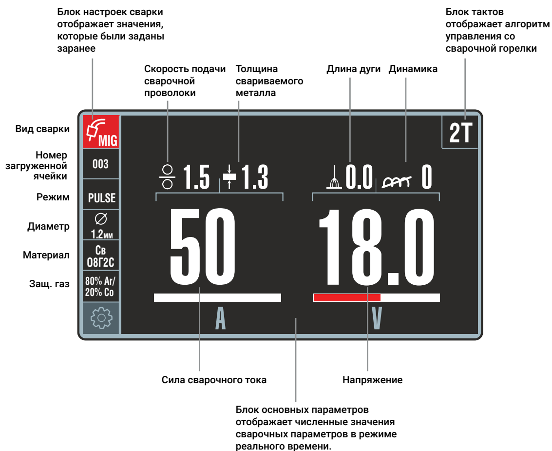
Рис. 19 – Блоки Главного экрана панели управления
