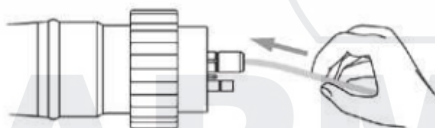
Рис. 33. ЗАПРАВКА ТЕФЛОНОВОГО КАНАЛА.
