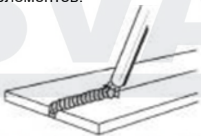
Рисунок 11. Нижнее положение при сварке
