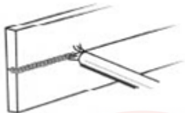
Рисунок 12. Горизонтальное положение при сварке
