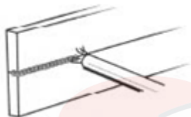
Рисунок 13. Горизонтальное положение при сварке
