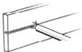
Рисунок 13. Горизонтальное положение при сварке
