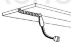
Рисунок 23. Сварка в потолочном положении
