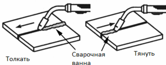
Рисунок 19. Направление движения горелки
