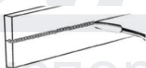
Рисунок 21. Сварка в горизонтальном положении
