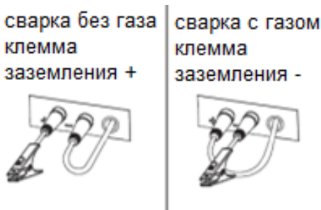
Рисунок 16. Полярность при полуавтоматической сварке
