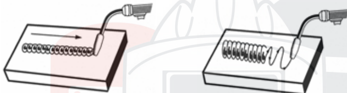
Рисунок 15. формирование сварного валика
