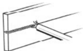
Рисунок 14. Горизонтальное положение при сварке
