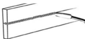
Рисунок 22. Сварка в горизонтальном положении
