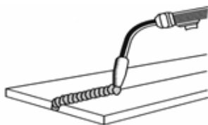
Рисунок 21. Сварка в нижнем положении
