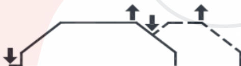
Рисунок 4. 2х тактный режим работы горелки
