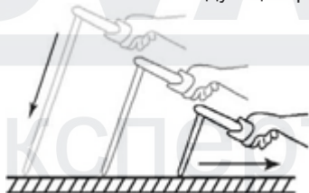
Рисунок 15. положение электрода при сварке
