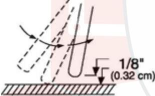
**Рисунок 8. Зажигание дуги**
