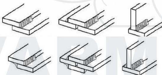
Рисунок 5. Угловые соединения
