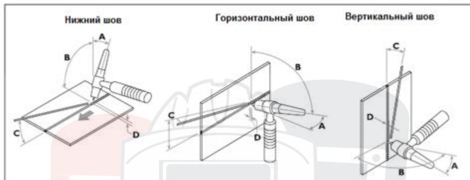
**Рисунок 18. Базовые движения при работе с аргонодуговой горелкой**
