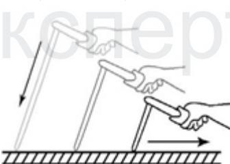
**Рисунок 9. положение электрода при сварке**
