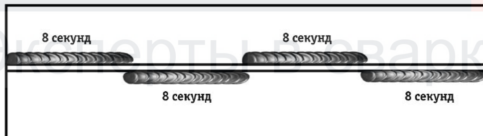
Рис. 9.14.1. Сварка коротких швов.
