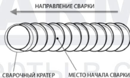
Рис. 11.2.2. Начало сварки при смене электрода.
