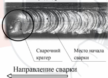
Рис. 9.2. Начало сварки при смене электрода.
