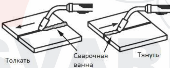
Рисунок 18. Направление движения горелки
