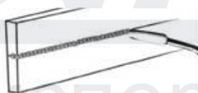
Рисунок 21. Сварка в горизонтальном положении
