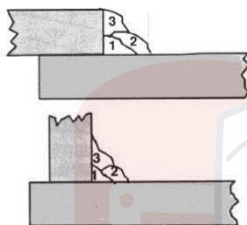
Рисунок 24. Многопроходная угловая сварка нахлесточных и тавровых соединений
