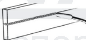
Рисунок 21. Сварка в горизонтальном положении
