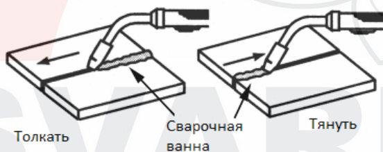
Рисунок 18. Направление движения горелки
