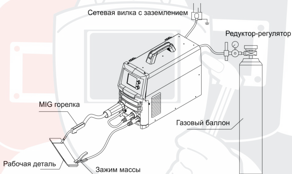
Рис. 3.1 Схема подключения в режиме MIG (сварка в среде защитных газов).
